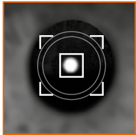
Автоматическое выравнивание по верхушке роговицы (вверх/вниз/вправо/влево)
